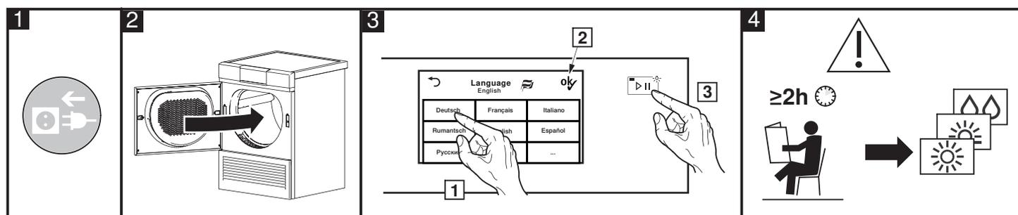
**!** Dopo ogni cambio del luogo di installazione, l'apparecchio con pompa di calore deve restare per circa 2 ore nella posizione definitiva prima di poter essere messo in funzione. La mancata osservanza di questa regola può causare danni all'apparecchio.
