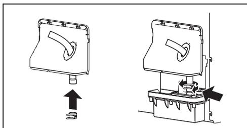
Collegamento del tubo di scarico
